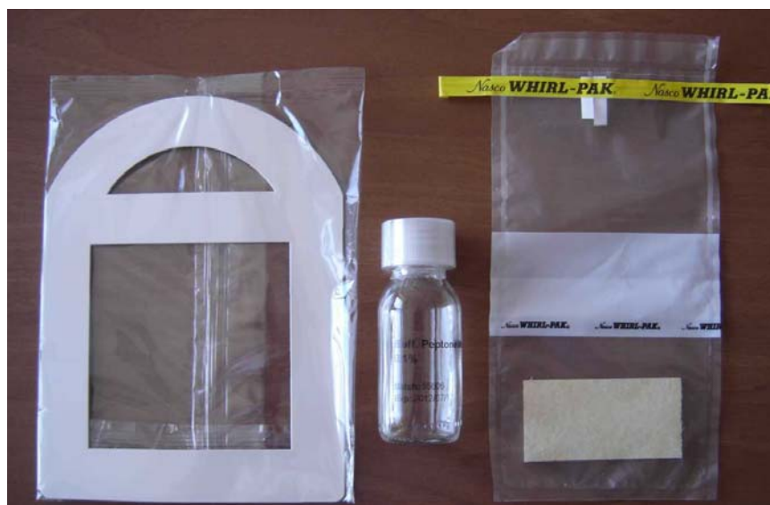
Рис. 4. Набір для відбору проб із застосуванням губки
